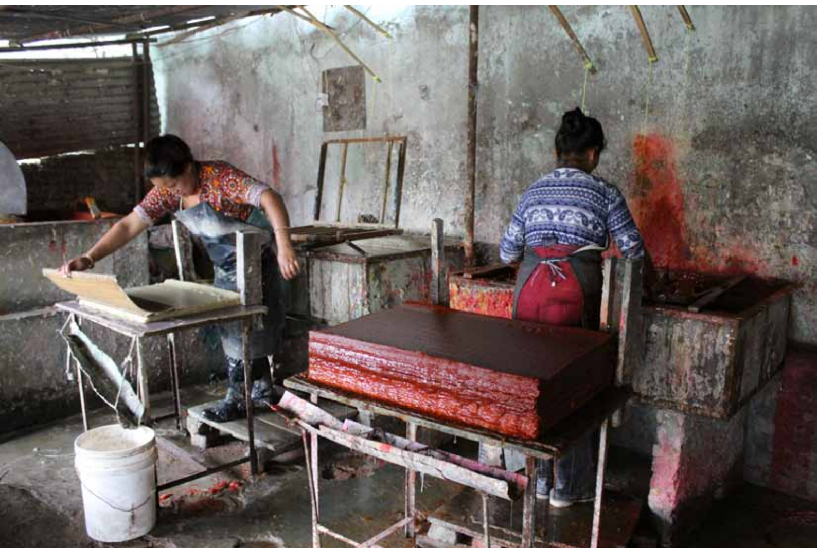
Bambusmåtten trækkes forsigtigt af papirarkene, der lægges i lag i bunker. (READ papirfabrik)
