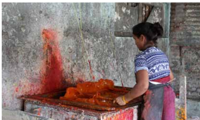
Papirfremstilling med japansk "skubbeteknik": Pulpen skubbes og fordeles i trærammen, så der dannes et papirark på bambusmåtten. (READ papirfabrik)
